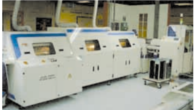
Bild 4: Inline-Anlage mit Vakuumtechnologie
