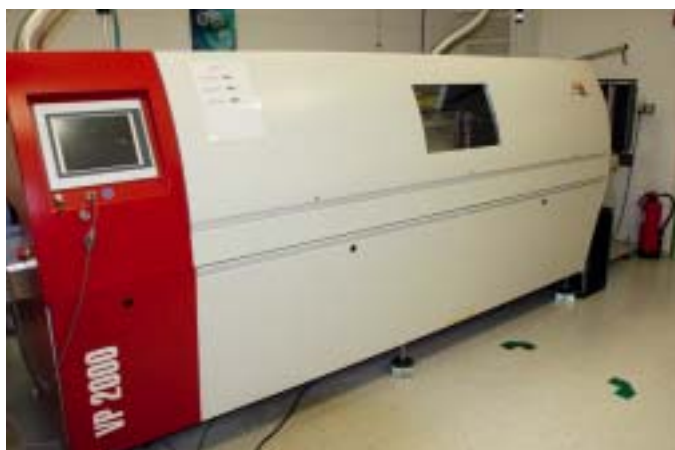
Die kleine Inline VP3000 wurde in die VP2000-Serie zur trägerlosen Verarbeitung von Baugruppen integriert
